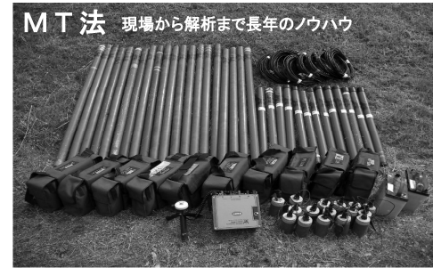
MT法 現場から解析まで長年のノウハウ MT法電磁探査は、自然の電磁場信号を用いて行なう比抵抗探査手法です。他の比抵抗探査手法よりも探査深度が深く、地下数+kmまで探査が可能です。このため、地殻構造調査や地熱構造調査に多くの実績があります。また、測定周波数の高いAMT (Audio Frequency MT) 法探査を用いることにより、地下1km程度までの詳細な探査も可能で、トンネル掘削前の土木地質調査や断層調査への実績があります。測定システムは可搬性に優れ、騒音振動はありません。
