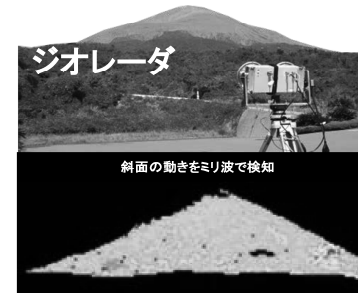
ジオレーダ 斜面の動きをミリ波で検知 ジオレーダはミリ波あるいはマイクロ波帯の電波を照射し、火山や地滑り斜面、鉱山切羽などで反射した成分を受信します。受信記録に差分干渉解析を適用することで、観測ターゲットの微小変位を常時モニタリングすることができます。レーダアンテナは水平及び垂直方向に回転する機構を備えていますので、面的なデータ集録が可能となります。
