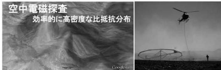
空中物理探査は、固定翼機やヘリコプターを用いて行う物理探査手法です。空中から調査を行うため、地表からアクセスが困難な地区の情報を容易に得ることができ、1日に数百kmにおよぶデータを取得することが可能です。測定項目には、磁場強度、重力、放射能強度および電磁場強度があり、お客様のニーズに合わせた測定項目をご提案いたします。
