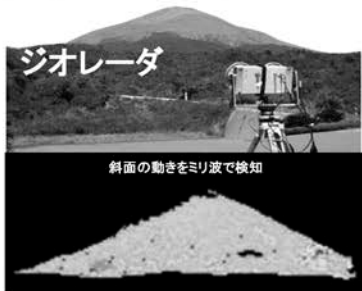
ジオレーダはミリ波あるいはマイクロ波帯の電波を照射し、火山や地滑り斜面、鉱山切羽などで反射した成分を受信します。受信記録に差分干渉解析を適用することで、観測ターゲットの微小変位を常時モニタリングすることができます。レーダアンテナは水平及び垂直方向に回転する機構を備えていますので、面的なデータ集積が可能となります。
