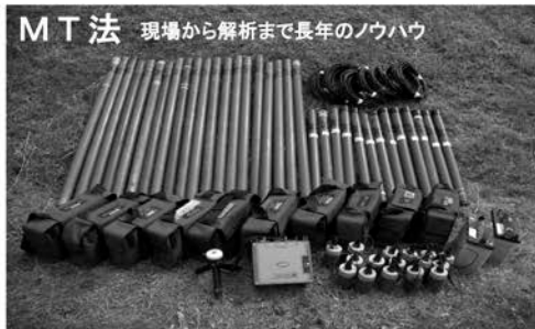
MT法 現場から解析まで長年のノウハウ MT法電磁探査は、自然の電磁場信号を用いて行なう比抵抗探査手法です。他の比抵抗探査手法よりも探査深度が深く、地下数十kmまで探査が可能です。このため、地殻構造調査や地熱構造調査に多くの実績があります。また、測定周波数の高いAMT (Audio Frequency MT) 法探査を用いることにより、地下1km程度までの詳細な探査も可能で、トンネル掘削前の土木地質調査や断層調査への実績があります。測定システムは可搬性に優れ、騒音振動はありません。
