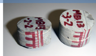
従来の古地磁気測定試料の例（10cm 3 程度）
