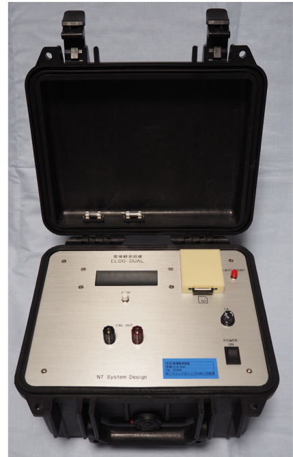
MT観測用 電場観測装置 ELOG-DUAL
