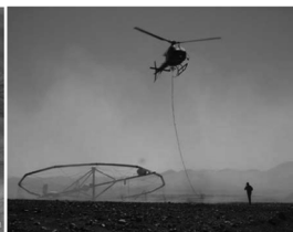
空中電磁探査 効率的に高密度な比抵抗分布
